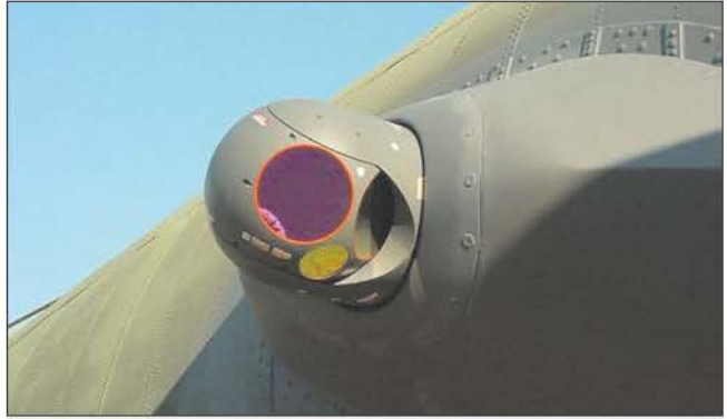
Оптико-электронный датчик комплекса радиоэлектронной защиты «Лаиркм» на самолете МС-130Н
