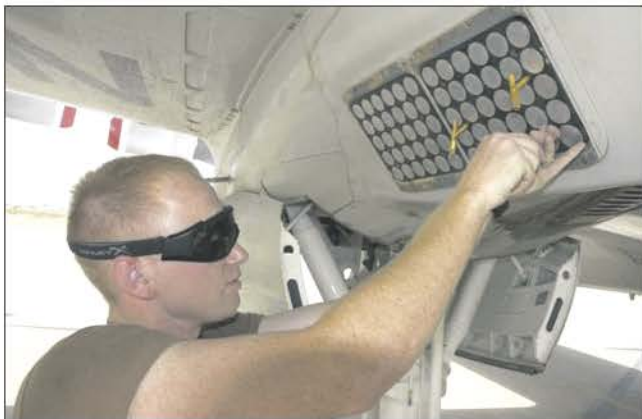
Автомат отстрела ложных целей AN/ALE-47(V) на борту самолета базовой патрульной авиации Р-3С «Орион»
