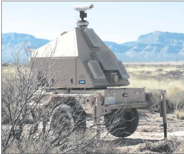
Внешний вид РЛС контрбатарейной борьбы CRAM компании «Техновэйтив эпликейшнс» в ходе проведения испытаний на полигоне Юма (штат Аризона)
